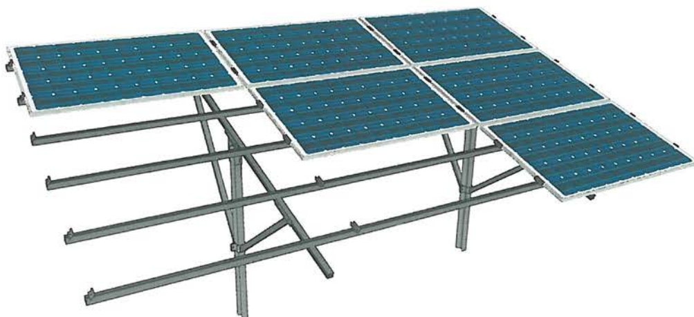
Rys. 1. Wizualizacja systemu montażowego oraz sposobu mocowania modułów fotowoltaicznych
