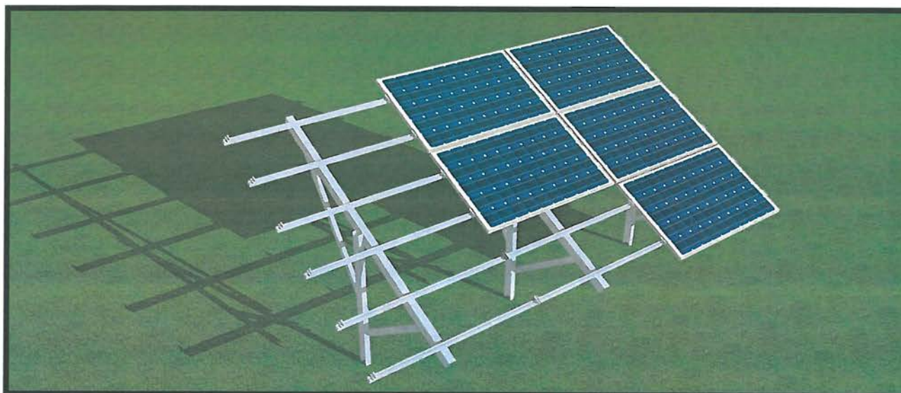
MONTAŻ MODUŁÓW W POZIOMIE
