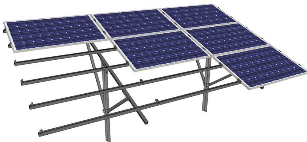
Rys. 1. Wizualizacja systemu montażowego oraz sposobu mocowania modułów fotowoltaicznych
